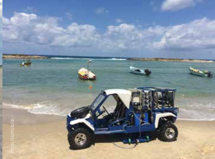
Das Galmobile beim Entsalzen von Meerwasser
